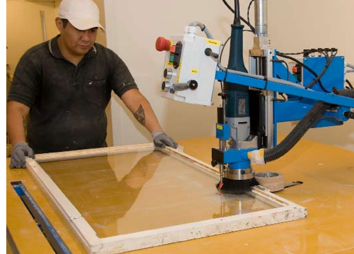
DEN HÄR NYA MASKINEN ÄR FÖNSTERVERKSTADENS NYA STOLHET. "KITTOFF" TAR BORT FÖNSTERKITT EFFEKTIVT UTAN ATT KROSSA GLASET.
